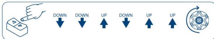
A anulação total dos fins de curso repõe automaticamente o impulso curto para a regulação da rotação da lâmina.
