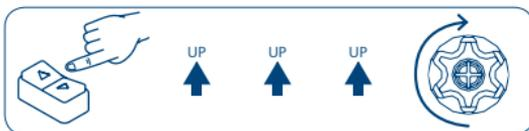
Como mostra o exemplo, quando a sequência termina positivamente, o motor executa uma única rotação longa. Se o motor não executar qualquer rotação, significa que a sequência não terminou com sucesso. Nesse caso, a sequência tem de ser repetida desde o início.
